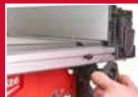
Posuvný kryt s ozubnicí a pastorkem umožňuje přesné a snadné nastavení vodítka u přední části pily
